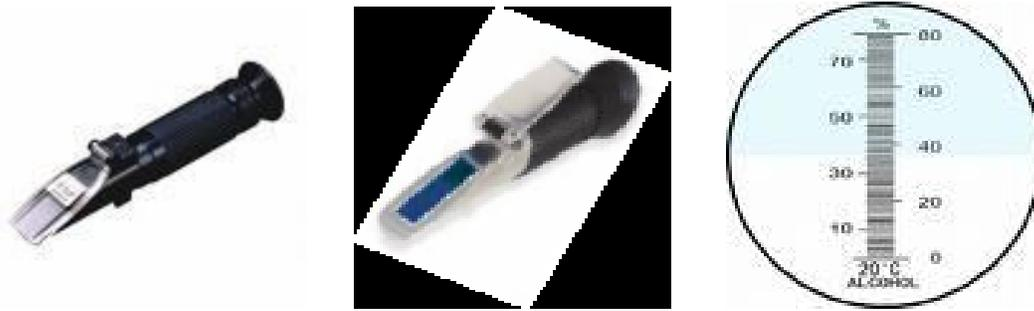
**Gambar 8.10.** Refraktometer.
