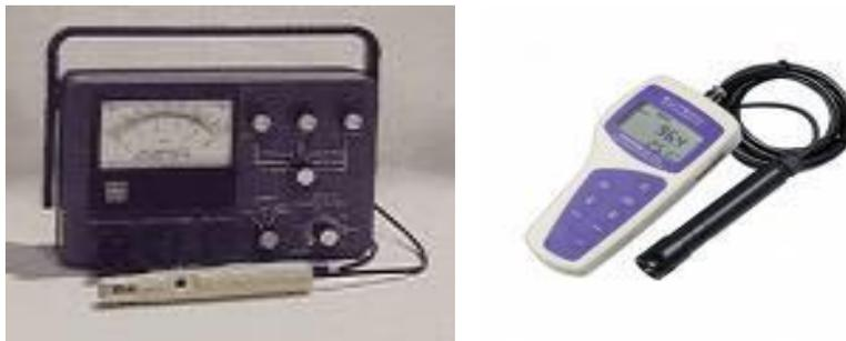
**Gambar 8.7.** DO meter manual dan DO meter digital.
